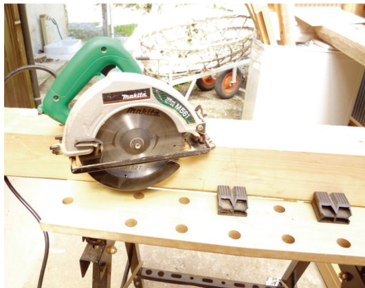
写真5 電動丸鋸と小さい作業台
