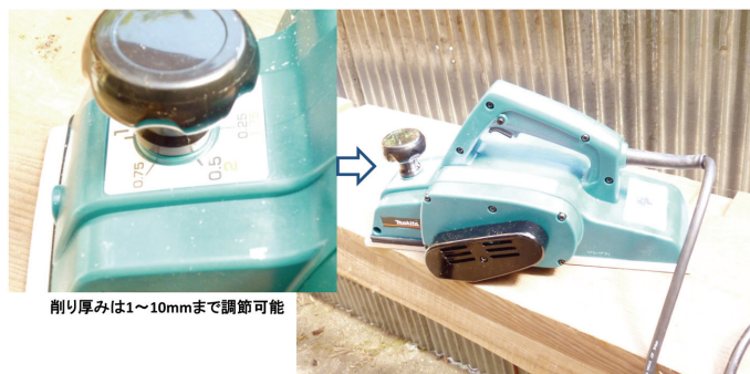
写真4 電気かんなとかんな削り台
