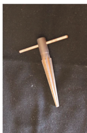
リーマー： ドリルでアルミシャーシに 開けた穴を広げる。
