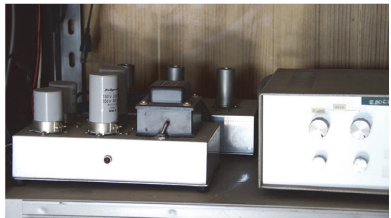
12AX7A を 3 本(後列)使用したイコライザーアンプ。 雑音に弱いので、シールドして使用してある。電源トランスもシールドされたもの。
