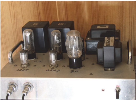
GT 管の 5 極管 42 を出力管に使ったアンプ。 整流も 80 という ST 管を使用したもの。
